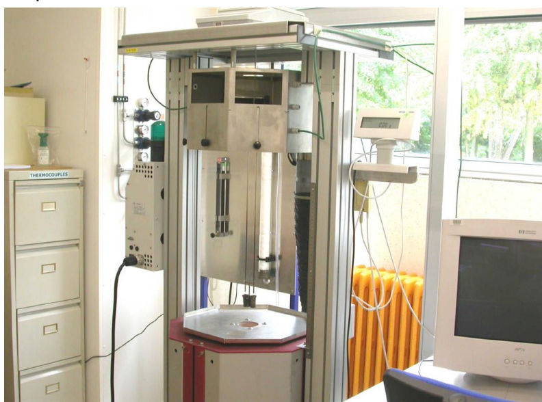
Photographie 1 : Dispositif d'analyse thermique différentielle et thermique gravimétrique
