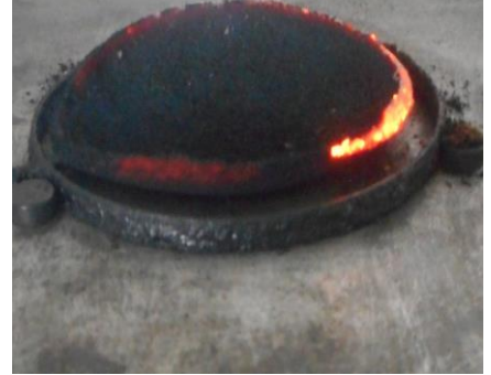
Aspect de la couche de 5 mm à la fin des essais à température >320°C.
